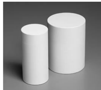
Obrázok 3. Materiály spekané pomocou mikrovlnnej energie
