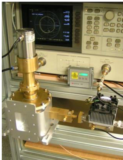
Obrázok 3. Materiály spekané pomocou mikrovlnnej energie
