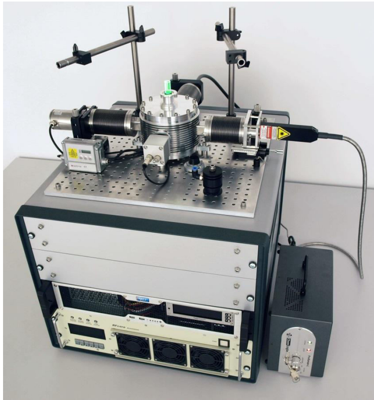
Obrázok 2. Mikrovlné zariadenie pre spekanie materiálu
