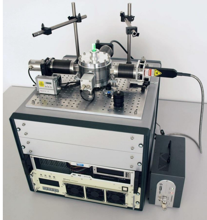
Figura 2. Dispositivo de microondas para el sinterizado de materiales
