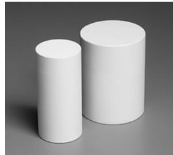
Фигура 3. Материали синтеровани чрез микровълнова енергия
