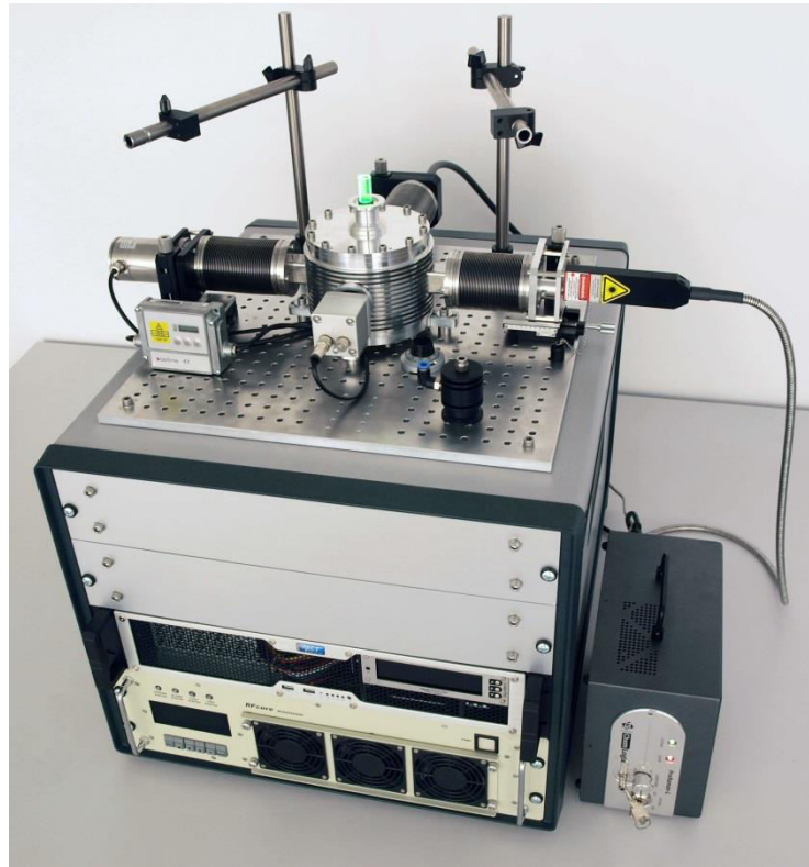
Illustration 2 : dispositif micro-onde pour le frittage des matériaux
