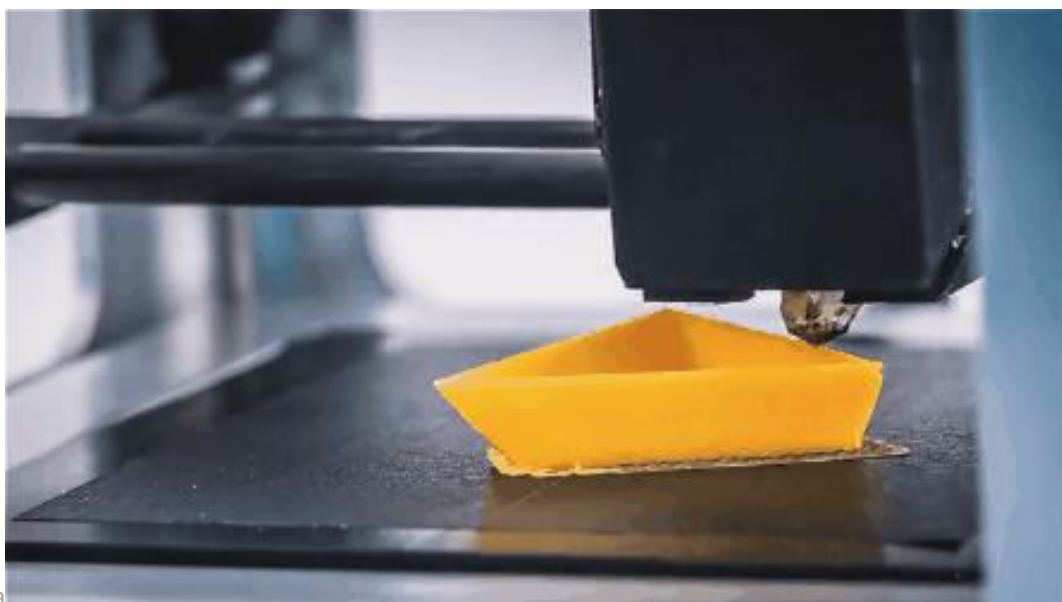
Figura 2. Obiectele sunt construite din straturi
