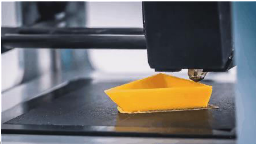
Figure 2. Les objets sont fabriqués grâce à la superposition de couches
